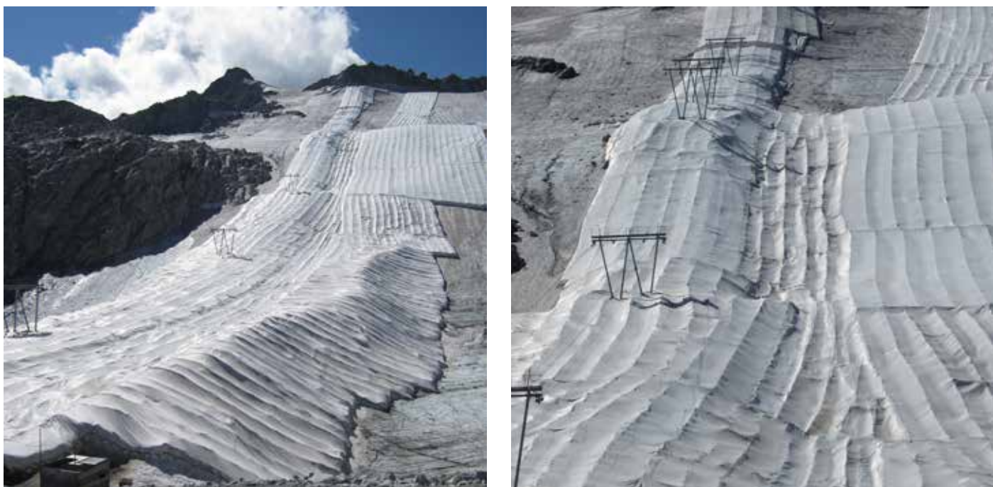
Fig. 2: Eksempler på at Albedo med COVERICE geotekstil er høyere enn de for ubeskyttet snø.
