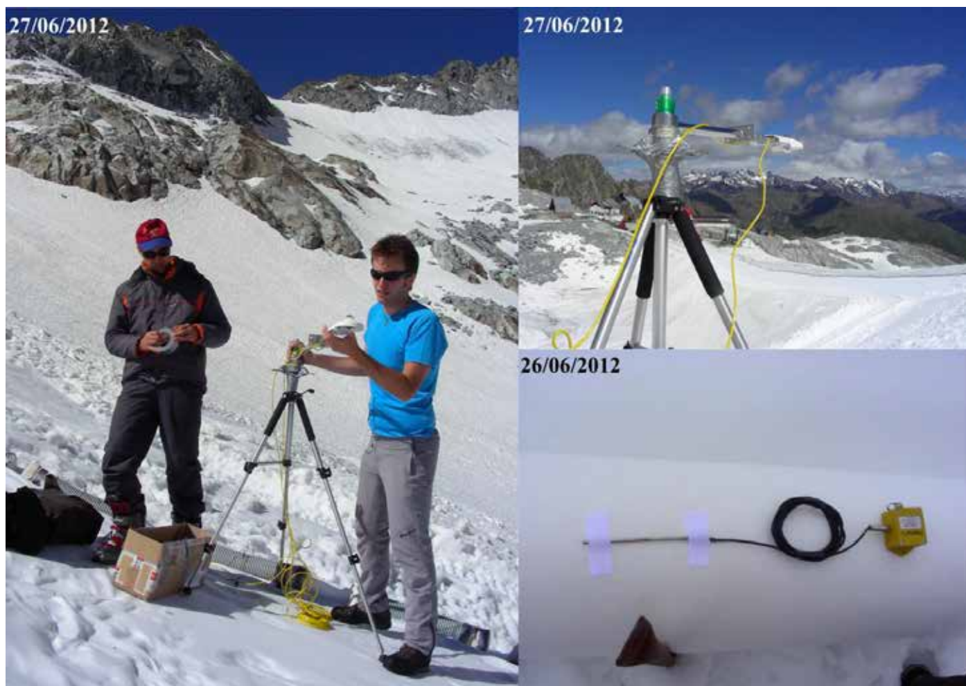
Fig. 1: Installasjon av Net radiometer for måling av albedo på overflaten (til venstre og til høyre over) og av termistorspisser og loggere (gul boks) under geotekstilene for å overvåke overflatetemperaturen (nederst til høyre).
